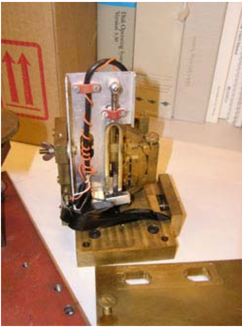
Kuva 30. Kyrön suunnittelema äänirautakatkoja asennettiin uusittuun spektrometriin
