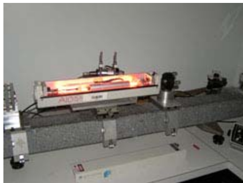
Kuva 35. Laitoksella toteutettu stabiloitu 1-mooditoiminen HeNe-laser.
