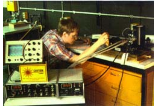
Kuva 33. Esko Kyrö toimi tuolloin laboratorioinsinöörin sijaisena ja osallistui diodilaserspektrometrin kehitystyöhön. Tässä hän on säättämässä diodilaserlähdettä.
