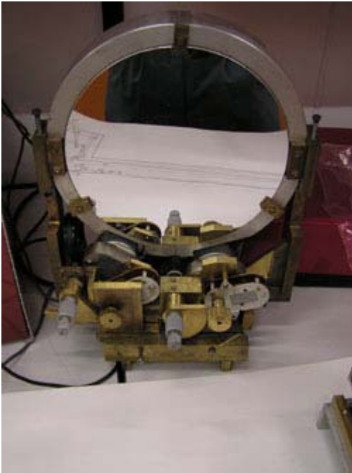
Kuva 20. Tärkeimpien peilien säädössä vaaditaan mikrometriä tarkkuutta.
