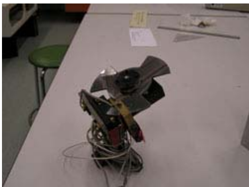
Kuva 15. Pyörivällä siipirattaalla katkottiin infra-punasäteilyä Fourier-spektrometrissäkin aluksi.
