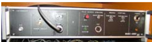
Kuva 34. MMC-amplifier rakennettiin ohjaamaan dynaamista peilin säätöä.
