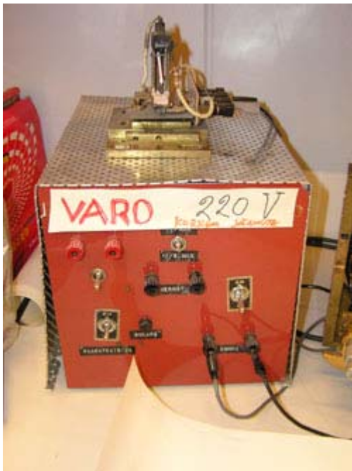
Kuva 18. Perinteisenä lähteenä Litrow-spektrometrissä käytettiin Nernst-sauvaa, jonka sytyttäminen vaati esilämmityksen.
