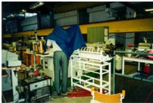
Kuva 45. Max-laboratoriossa infrapunaspektrometri on sijoitettu avoimeen ja valoisaan mittaushalliin. Spektrometrin säätöjä täytyi joskus tehdä sen vuoksi hupun alla. Oulussa rakennettu moniheijastuskyvetti erottuu valkorunkoisena.
