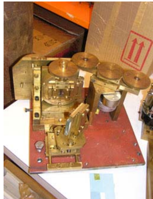
Kuva 19. Spektrometrin toiminnan kannalta tärkeä raon säätö tehtiin motorisoidulla hammaspyörävaihteistolla.
