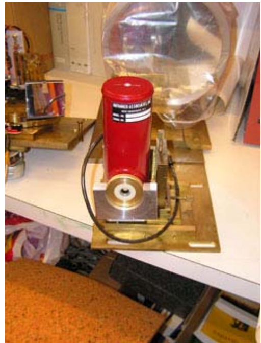
Kuva 31. Laitteeseen ostettiin uudet puolijohdedetektorit, kuvassa oleva indium-antimoni (InSb) ja elohopea-cadmium-telluridi (MCT) ilmaisain.
