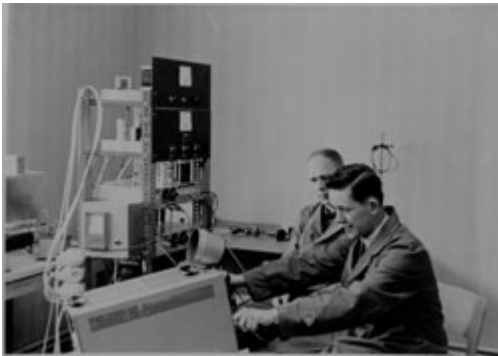
Kuva 7. Matti Tilli (taimainen) ja Rauno Anttila virittelevät spektrometrin elektronikka, jonka ensimmäinen versio oli toteutettu elektroniputkilla.
