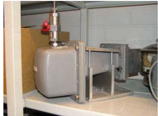
Kuva 5. 1970-luvulla Unicam-spektrometrillä tehtiin joitakin tutkimuksia ilmakehän painetta suuremmissa kaasunpaineissa olevista molekyyleistä. Näihin mittauksiin käytettiin kuvan lujarakenteista kyvettä.
